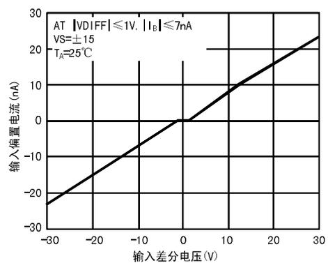
图7. 输入偏置电流 vs. 差分电压
