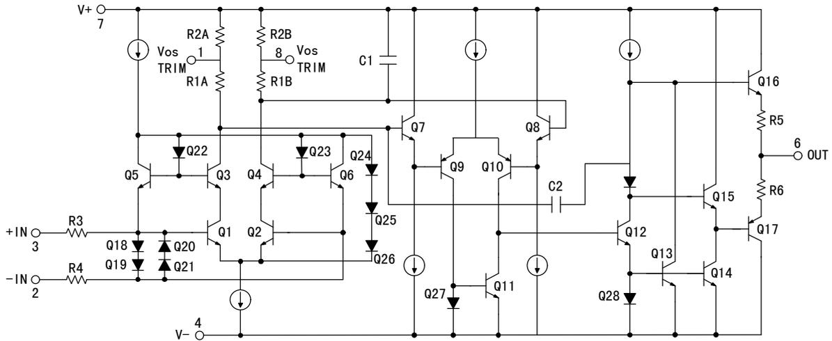
图 1. OP07 内部简化电路图
