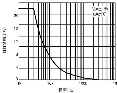
图18. 不同频率的输出电压摆幅
