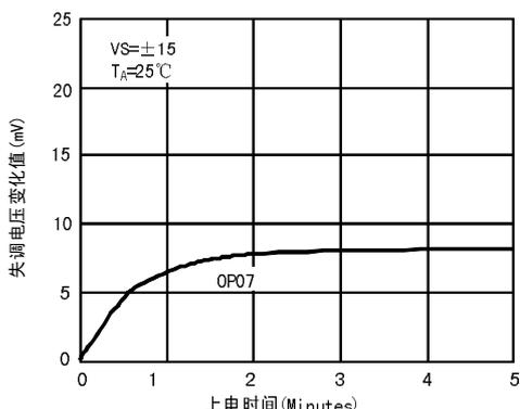
图6. 器件发热对失调电压的影响
