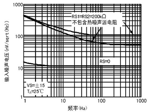
图11. 总输入噪声电压 vs. 频率
