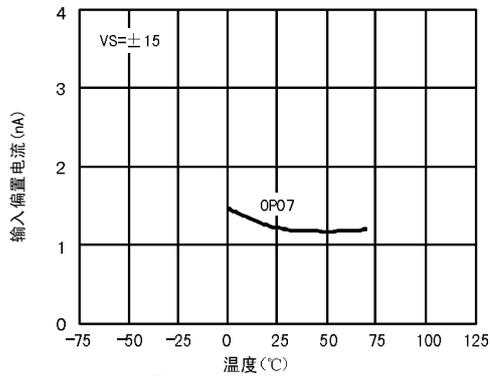
图8. 输入偏置电流 vs. 温度
