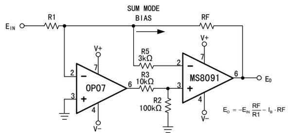
图 28. 高速、低失调的复合放大器
