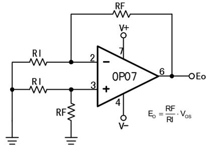
图 26. 典型失调电压测量电路
