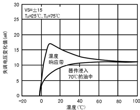
图4. 温度突变对失调电压的影响
