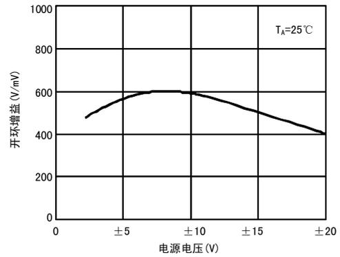
图15. 开环增益 vs. 电源电压
