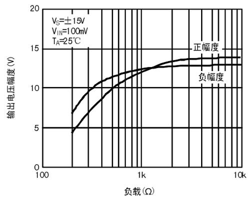
图19. 输出电压摆幅 vs. 负载
