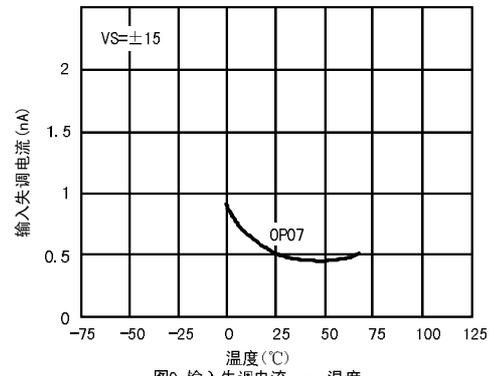
图9. 输入失调电流 vs. 温度
