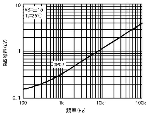
图12. 输入频带噪声 vs. 频率
