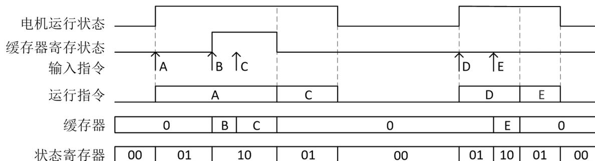
步进电机的运行指令 (Mode, Cycle, Rt, Pulse) 在 Pulse 寄存器所在地址 (的数据) 写入完成之后确定。当前指令运行时，再次输入的数据会暂存于 Cache 寄存器，在当前指令完成后被接续。Cache 中已经寄存数据时仍可接收新输入的数据，新输入的数据会覆盖原有数据。
