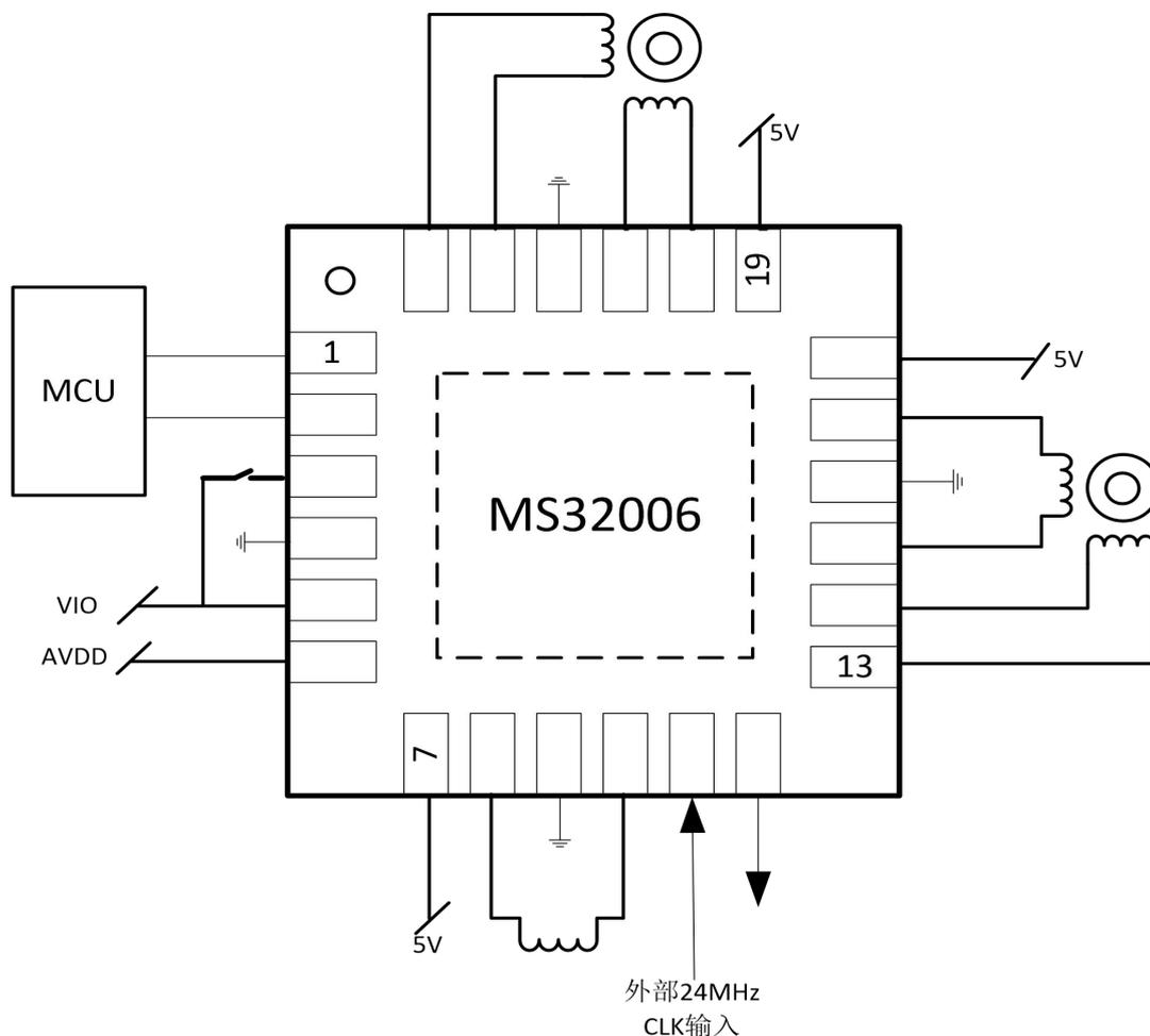
注：1. MS32006 具有背部散热 pad，大功率应用时必须接地。
