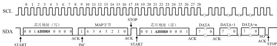
图 2. 控制端口时序，I2C 从模式读
