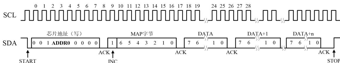
图 1. 控制端口时序，I2C 从模式写
