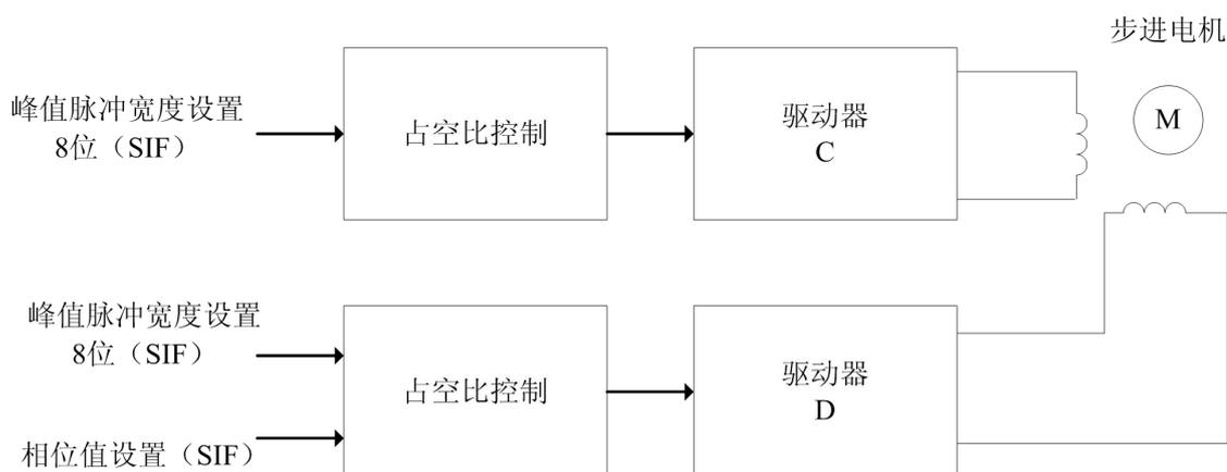
步进电机的模块控制图如上，通过寄存器设置可以用来执行一系列的控制操作
