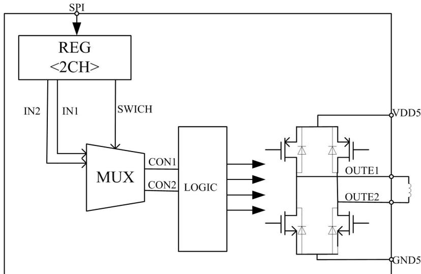
直流电机（摄像机中用于 IR-cut）驱动采用 PWM 控制方式。芯片寄存器 REG<2CH> bit2 SWICH 上电默认 ‘0’，使用时此开关寄存器必须置 ‘1’ 时，数字串行 SPI 输入有效
