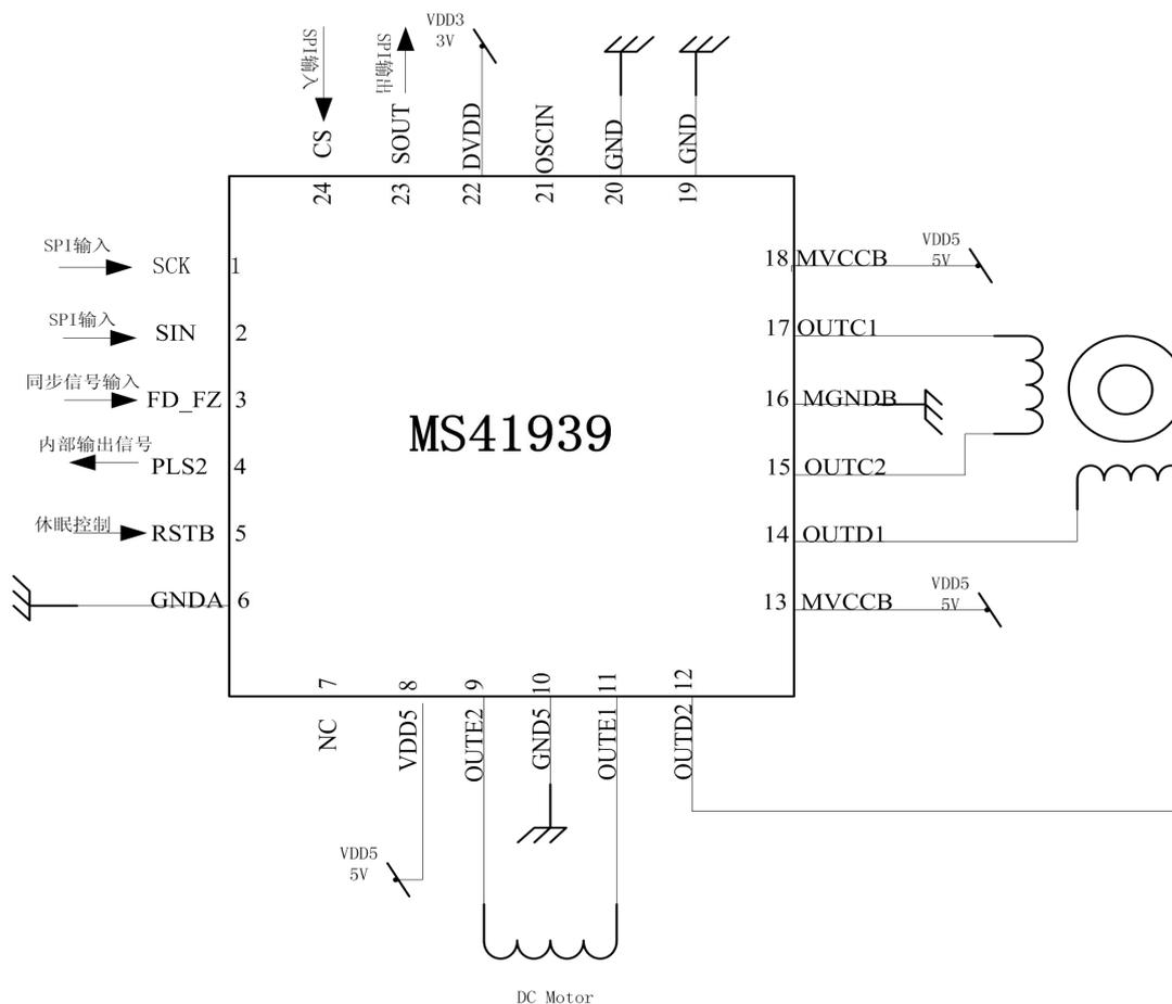
1. MS41939 具有背部散热 pad，大功率应用时最好接地。
