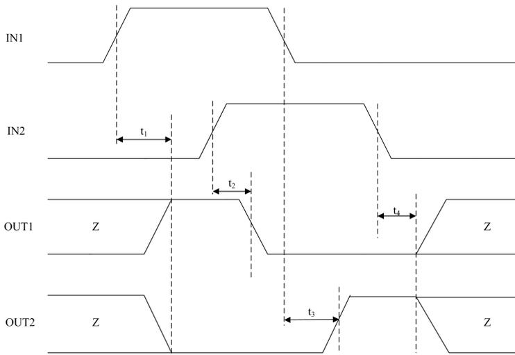
图 2 MS31001 输入输出时间参数 1
