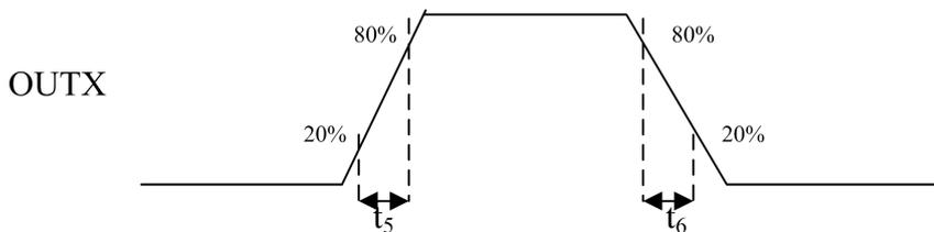
图 3 MS31001 输入输出时间参数 2
