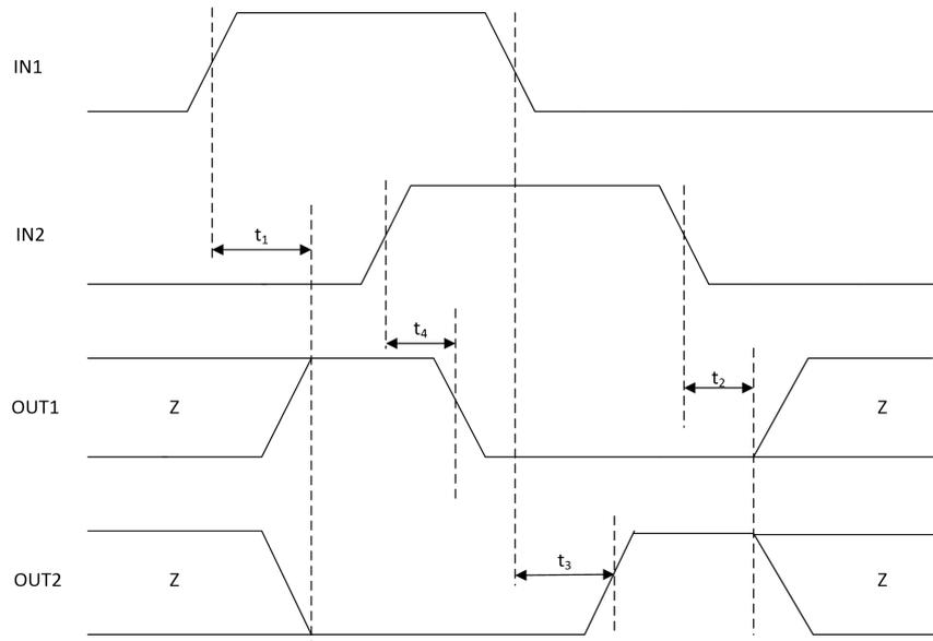
图 1. MS3111S 输入输出时间参数 1
