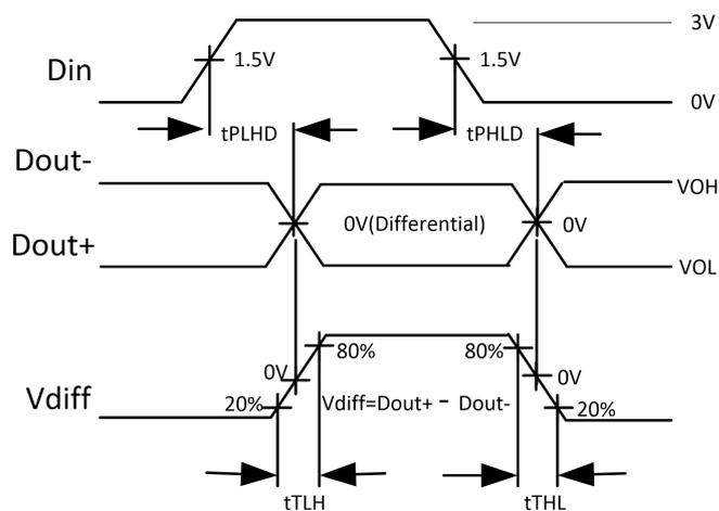
图 3. 传输延时和沿转变时间波形图
