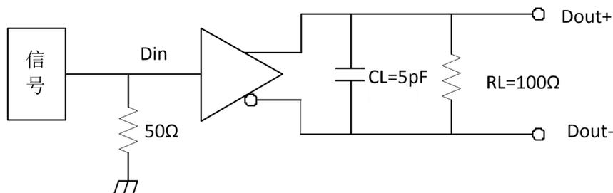
图 2. 传输延时和沿转变时间测试电路
