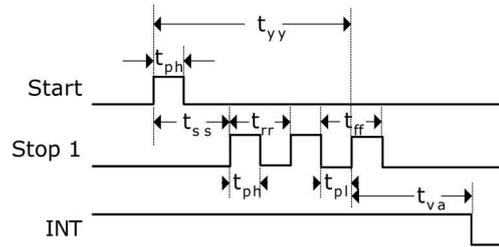
每一个输入端均可被单独设置成上升沿或者下降沿触发有效可通过设置寄存器 0 的 bit0-2 (NEG\_START, NEG\_STOP1)选择触发沿。
