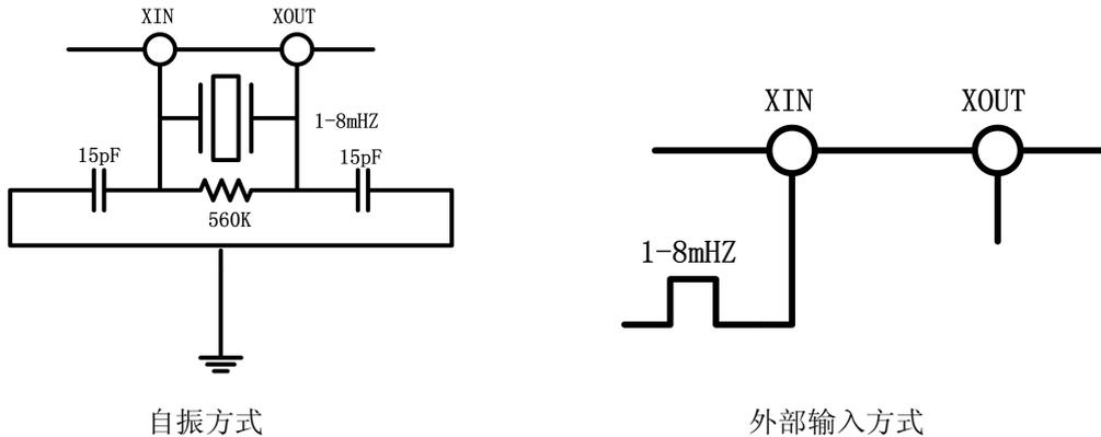
高速振荡器在默认情况下是起振状态，在一直起振的状态下，平均工作电流为 260  $\mu$ A。但是晶振仅在测量时间的时候需要开启，所以高速振荡器可以通过内部电路控制开启时间。通过设置参数 START\_CLKHS 来实现。当设置 START\_CLKHS > 1 时，晶振将会在发送 Start\_TOF, Start\_TOF\_Restart, Start\_Temp 或 Start\_Temp\_Restart 命令之后的测量中开启。在开启晶振与测量之间设置一个延迟以保证晶振有充足的时间震荡达到满振幅，用户根据使用的晶振进行设置起振时间，晶振具体起振时间见前面参数表。
