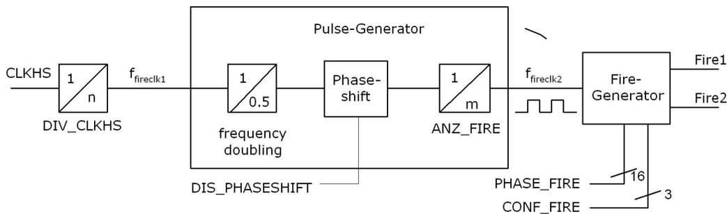
基准时钟的频率先通过内部进行倍频, 然后由 DIV\_FIRE 进行分频, 最低分频到 64 分频, 可以满足气体下的一些低频率的换能器。
