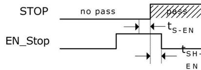
图 3. 关闭 STOP 通道时序
