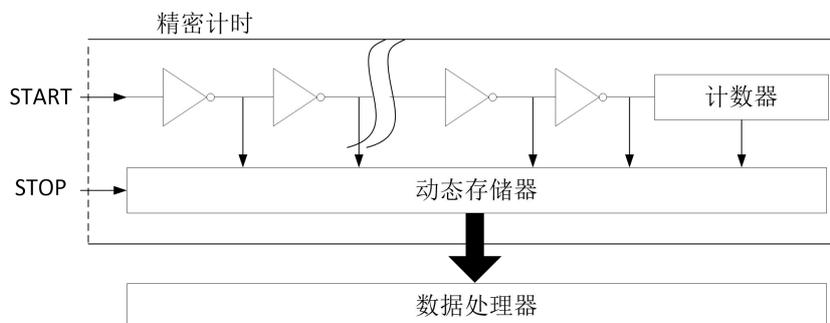
时间测量是通过一个 start 信号触发, 通过内部防抖处理后, TDC 的门电路开始高速计数, 直到 stop 信号产生记录计数结果, 达到 STOP 预期脉冲数后停止计数。
