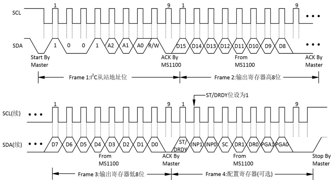
图 2. MS1100 的读操作时序图
