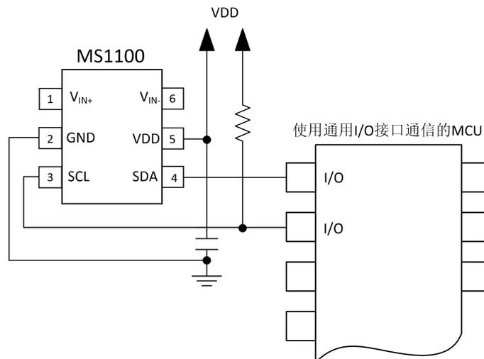
图 6. 对单个 MS1100 使用通用 IO 口
