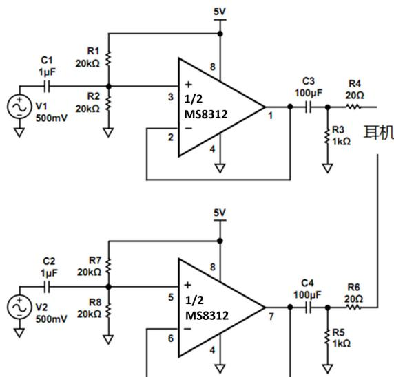
图中，R1 和 R2 将输入电压偏置为电源电压的一半，使信号的带宽范围最大化。C1 和 C2 用来 ac 耦合输入信号。C1, R1, R2 组成一个高通滤波器，他的拐点频率为  $1/[2\pi(R1||R2)C1]$ 。MS8312 的高输出可以驱动大电阻负载。
